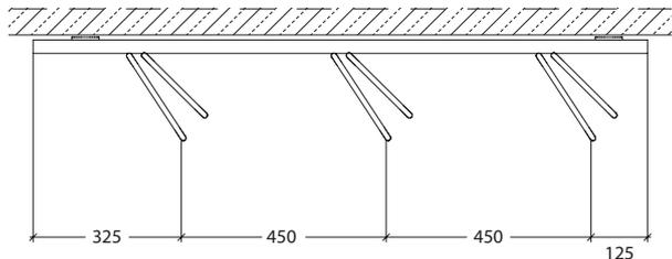
Seitenansicht einseitig tief zum Einbetonieren
