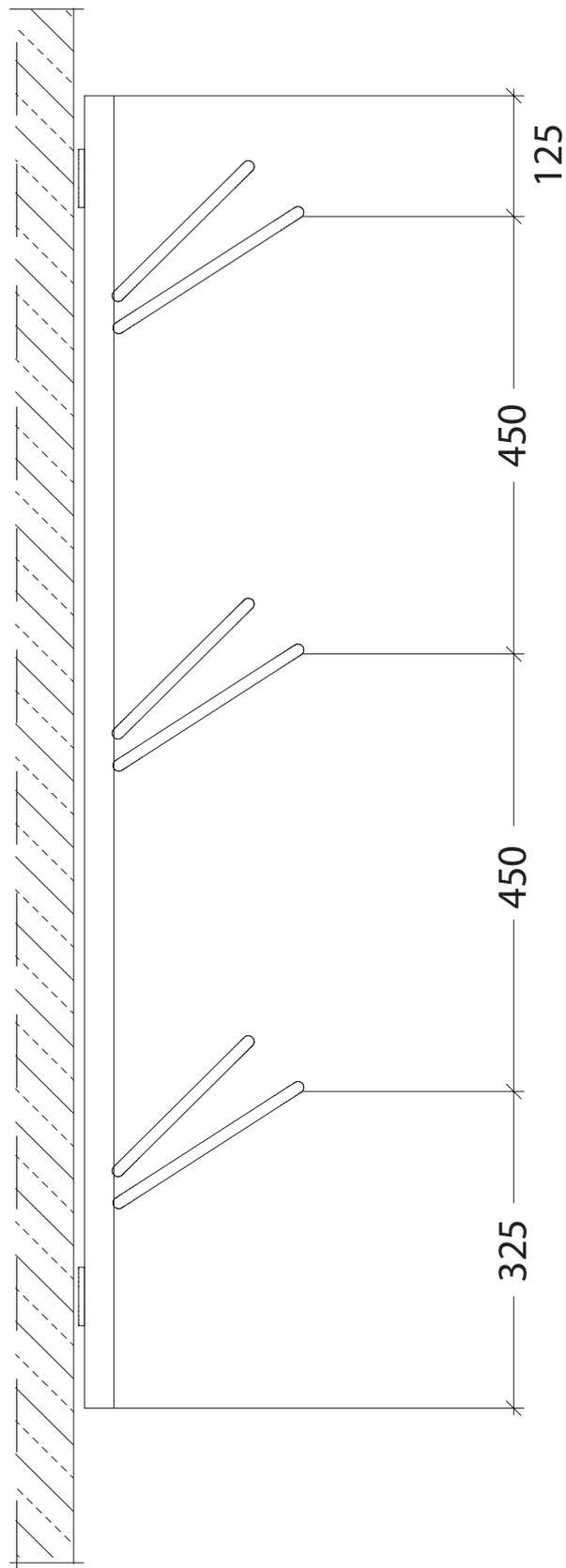
einseitig tief zum Einbetonieren
