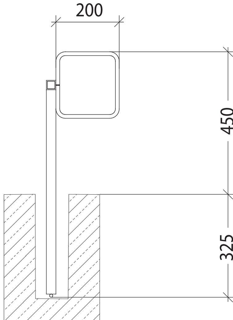
einseitig tief / hoch zum Einbetonieren
