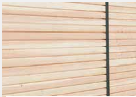
Holzbelattung Douglasie, 85 x 35 mm blickdicht, waagrecht, unbehandelt bzw. lasiert
