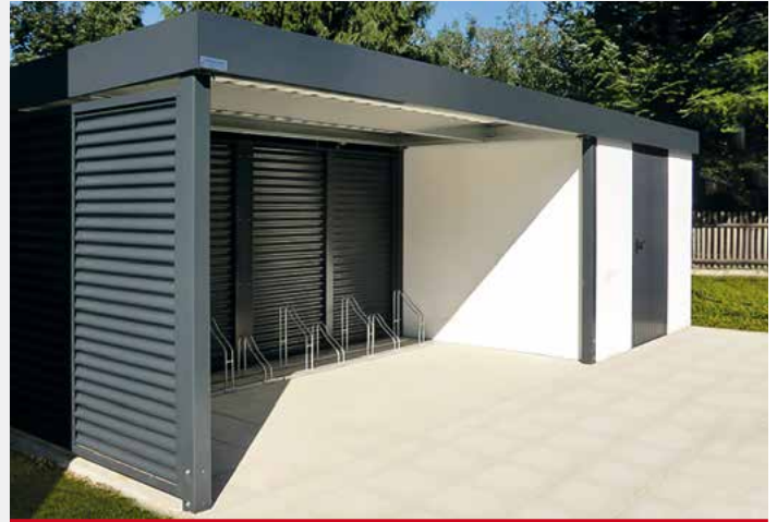
SILENOS FAHRRADÜBERDACHUNG Für 10 Fahrräder. Mit integriertem Gerätehaus, Dachfläche 7,38 x 2,50 m, 4 Stützen aus Quadratrohr 100 / 100 mm. Mit Wänden Stahlwelle in RAL 7016. Zubehör optional Dachbegrünung.
