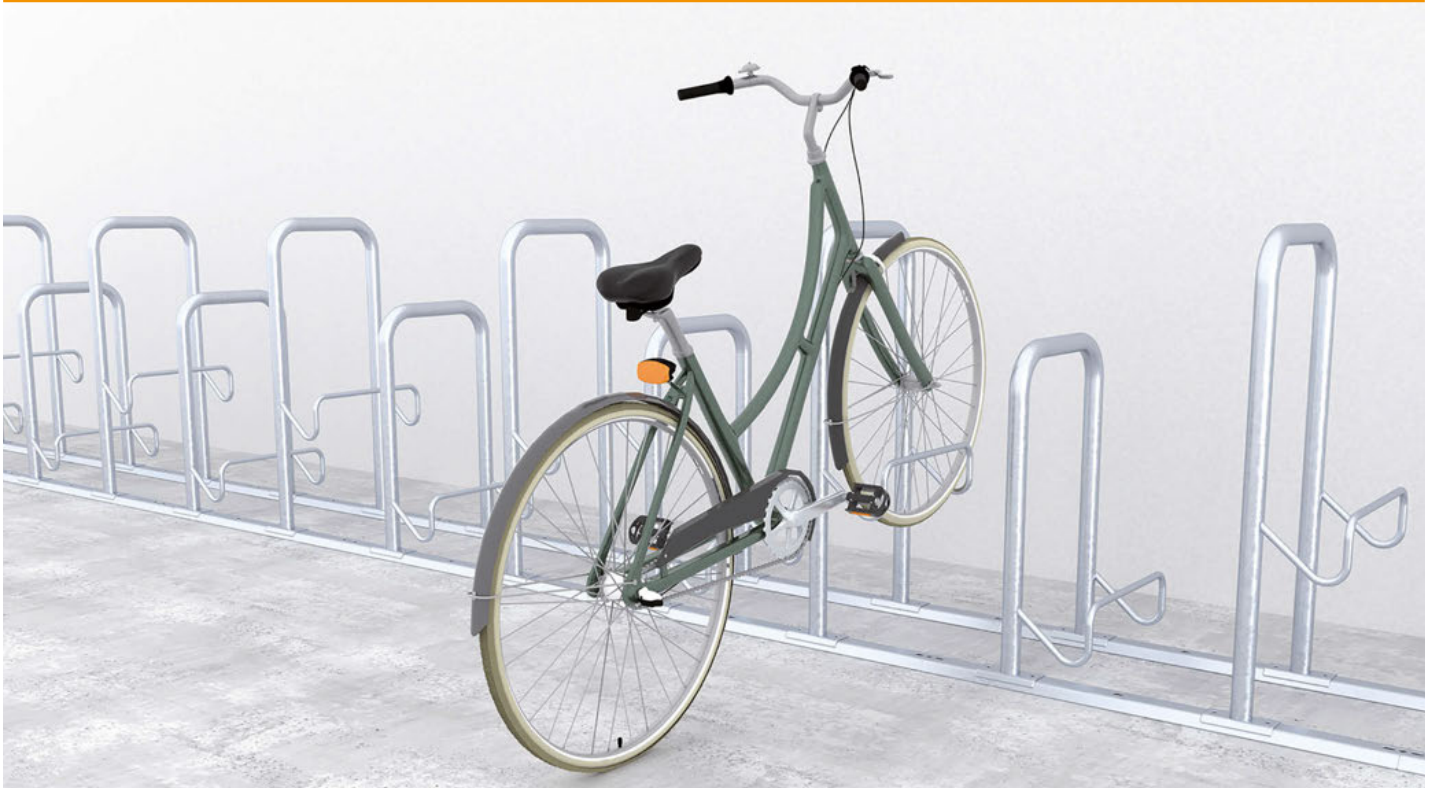
ATEGA einseitig tief / hoch verzinkt und konserviert als Reihenanlage zum Aufdübeln mit Radabstand 500 mm.
