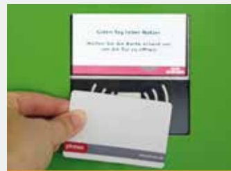
Schließfachanlage mit Zugang mittels RFID-Kartenleser.
