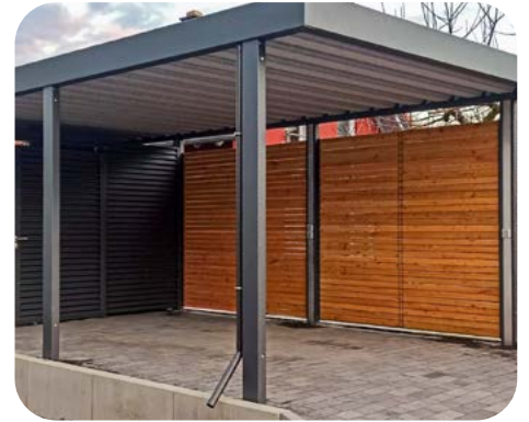
↑ Entwässerung über Fallrohr Über umlaufendes Rinnensystem der Attika wird entwässert. Anbringung des Fallrohres frei wählbar an Ecken. Wahlweise ober- bzw. unterirdische Entwässerung.
