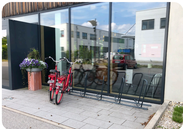
↑ Sophia einseitig, 60° links, Stahl feuerverzinkt, oberirdische Montage
